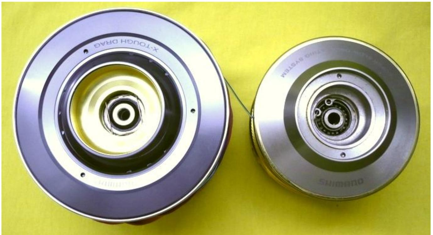
Obere und untere Bremsscheiben entsprechen im Durchmesser der 10 u. 20000. Durch den größeren Spulendurchmesser verringert sich die maximale Bremskraft um ca. 5kg auf 20kg. Wenn die unteren Bremsscheiben größer dimensioniert wären könnten höhere Bremskräfte erreicht werden. Platz dafür wäre in der großen Spule reichlich vorhanden.
