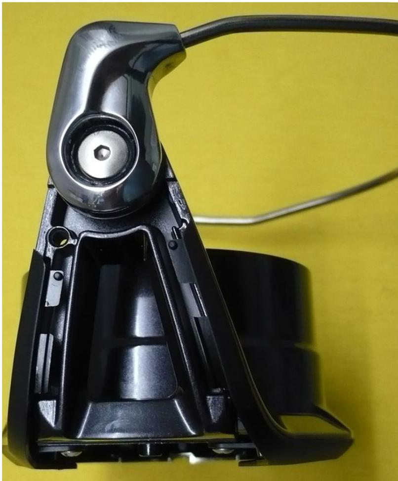
Gegen Korrosion sollte unter den Abdeckungen gefettet werden
