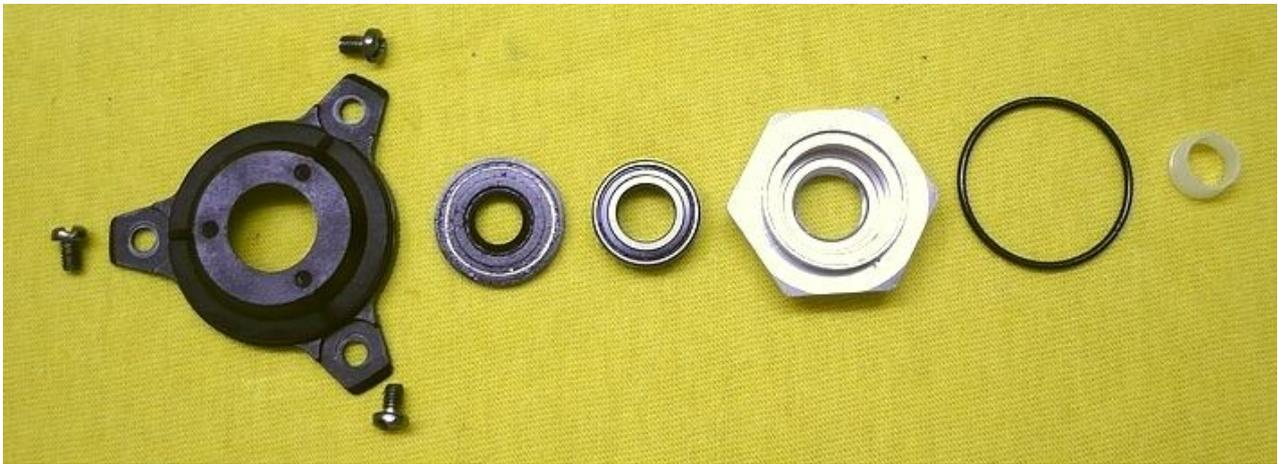
Alle Teile der Rotorbefestigung
