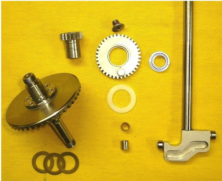
Hubachse mit eingeklebten Slide, Getriebezahnrad, Distanzscheiben, kleines Getriebezahnrad, Exzentrerrad mit U-Scheibe, Kugellager, Sicherungsmutter und Kunststoffhülse die auf den Mitnehmer gesteckt wird.
