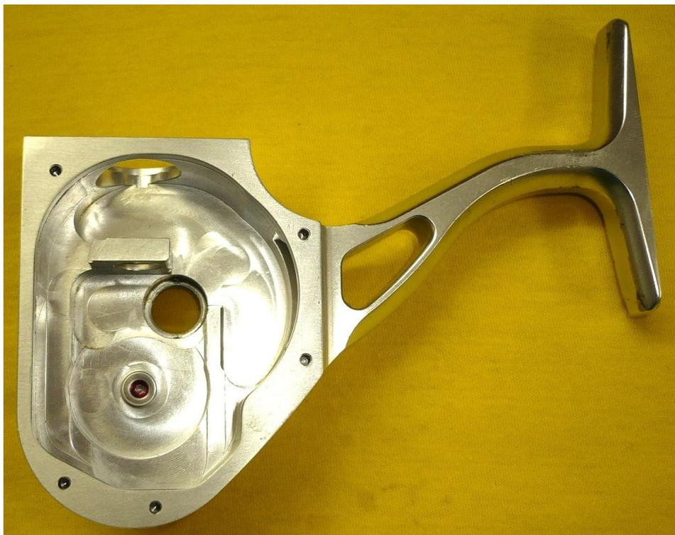
Sauber gefrästes Gehäuse. Deckel, Gehäuse und aufgeschraubte Rücklaufsperr haben höchste Paßgenauigkeit.
