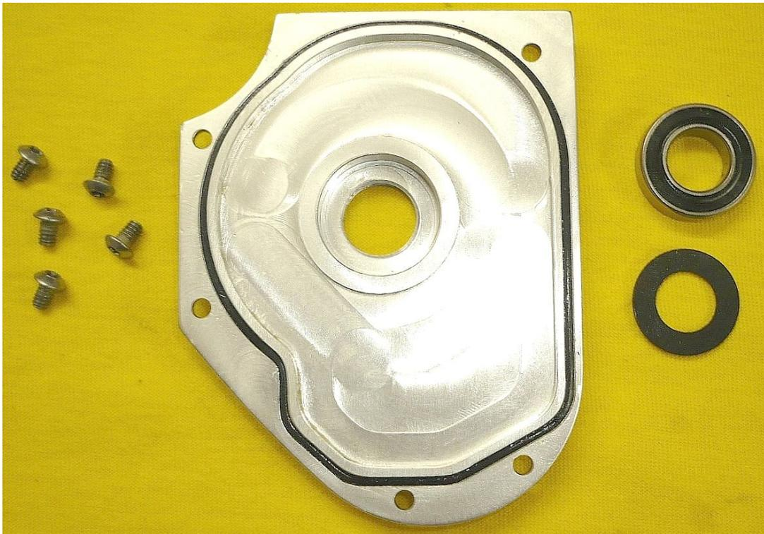
Sauber gefrästes Teil mit umlaufender Gummidichtring. Gegen Eindringen von Seewasser wurde eine Dichtung integriert.
