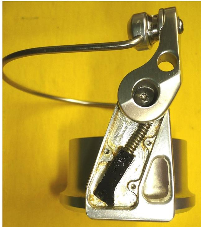
Relativ kurze aber starke Bügelfeder. Der Bügel kann nur per Hand umgelegt werden!
