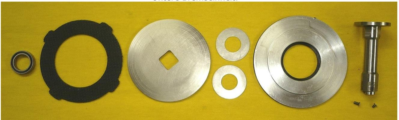
Kugellager, CFK Bremsscheibe, Bremsdruckplatte, Distanzscheiben, Abdeckkappe, Spulenaufnahme der unteren und oberen Bremseinheit, Konterschrauben der Bremseinstellmutter (v.l.n.r.)
