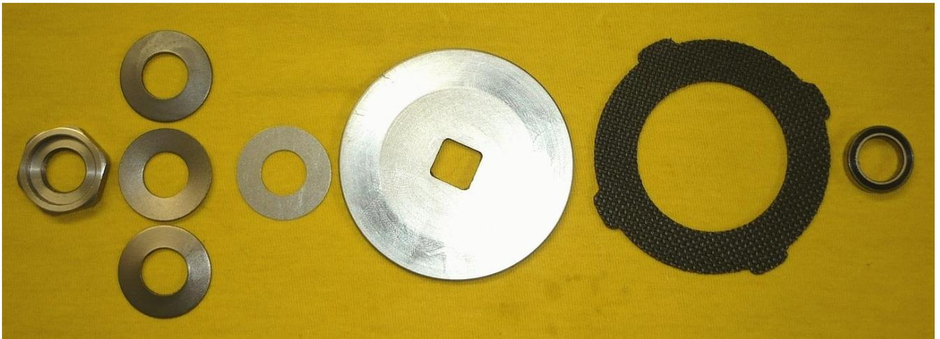
Bremseinstellmutter, drei Bellevilles, Distanzscheibe, Bremsdruckplatte, CFK Washer, Kugellager (v.l.n.r.)
