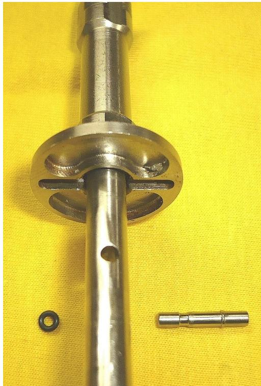
Die Spulenaufnahme auf auf der Achse, mit Haltesttift und Sicherungsring
