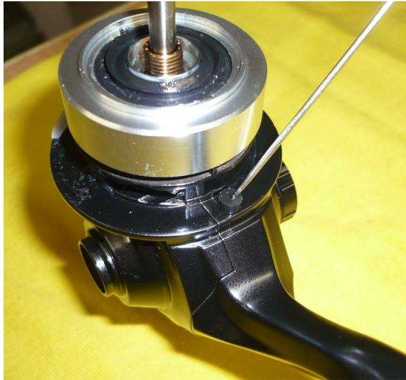
3. Dann mit einem dünnen Kreuzschraubendreher die Schraube losdrehen. Die verbleibt dabei in einer Kunststoffbuchse im Gehäuse! Also nicht versuchen die rauszuschütteln!
