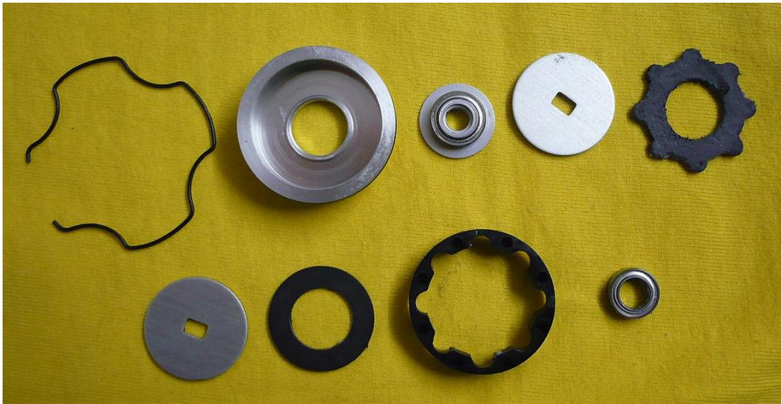
Alle Teile reinigen und mit Cal` s fetten.
