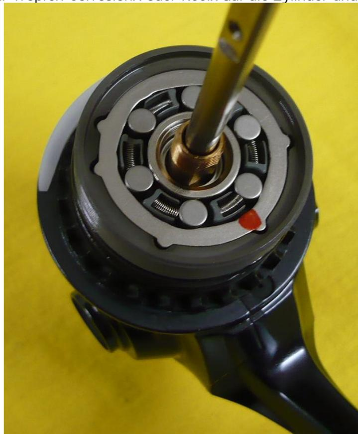
Wenn die Rücklauf Sperre zerlegt werden muss, ist es hilfreich die Lager der Teile zu markieren.
