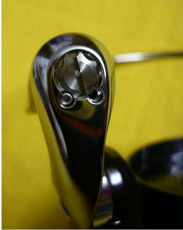
Die Schraube ist mit einer winzigen Madenschraube gesichert. Rausdrehen mit dem gleichen Bit wie für die Madenschraube der Spulenstütze. Gut gesichert aufbewahren.
