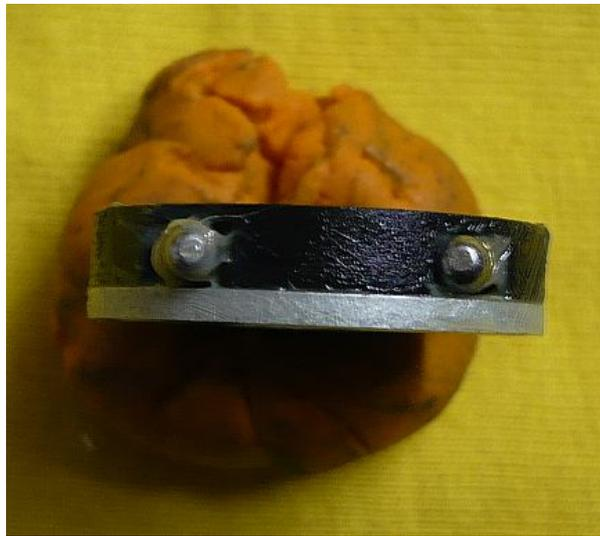
Damit die Federn und Pins beim Einsetzen nicht herausfallen, diese mit etwas Cal` s sichern!
