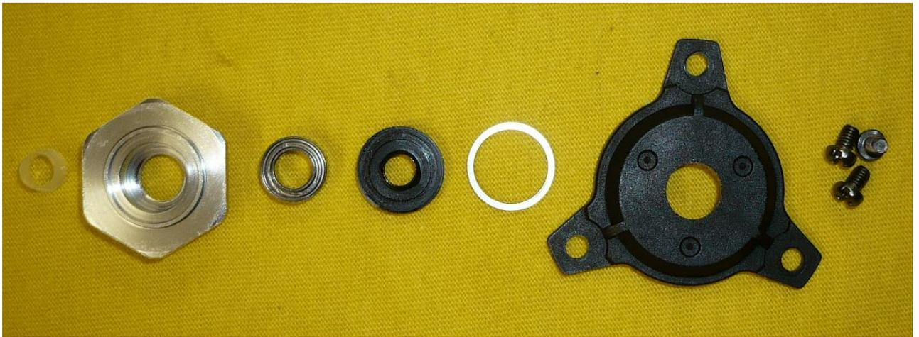
Alle Teile der Rotorbefestigung. Besonders auf die Plastikhülse achten die später leicht übersehen wird.
