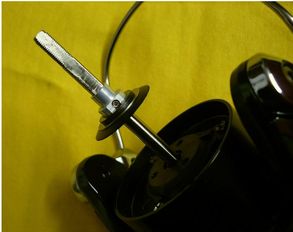
Abnehmen der Spulenstütze. Dazu muss die winzige Madenschraube entfernt werden.
