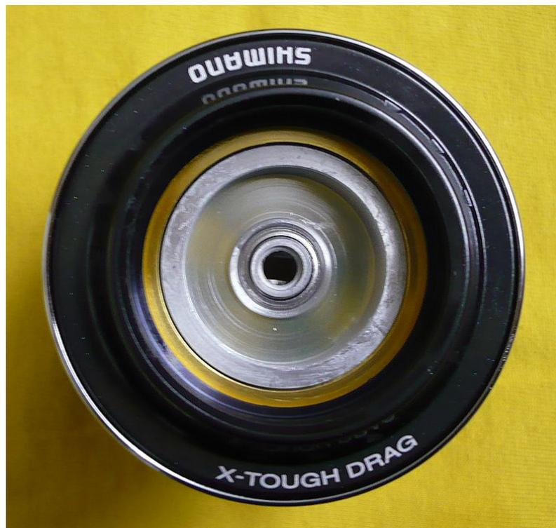
die ganze Bremseinheit nicht versuchen von oben herauszunehmen. Beschädigt nur den Deckel. Die ganze Einheit von unten mit einem Stab herausdrücken.
