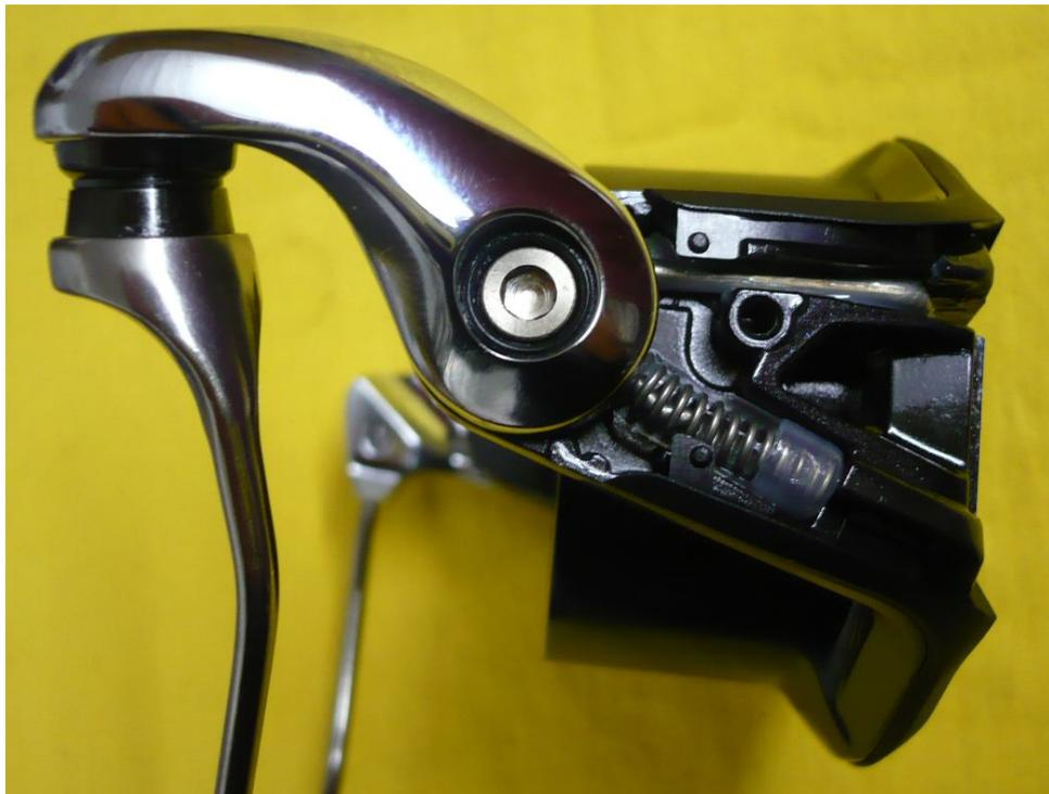
Bei normaler Wartung braucht der Bügelumschlage Mechanismus nicht zerlegt werden. Beim Abschrauben der Abdeckkappe „springen“ keine Teile entgegen. Also keine Angst den Deckel abzunehmen.
