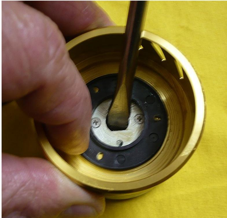
Bevor die drei Sicherungsschrauben wieder eingedreht werden, die Ratsche auf Funktion testen
