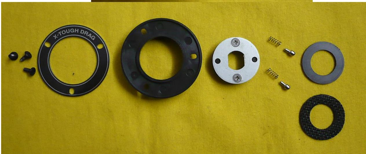
Zum Öffnen der unteren Bremsscheibe die drei Schrauben lösen. Alle Teile können dann mit einer Pinzette herausgenommen werden. Beim Reinigen und späteren Zusammenbau auf die Kleinteile der Ratsche achten! Die Dartainiumscheibe wurde gegen CFK getauscht
